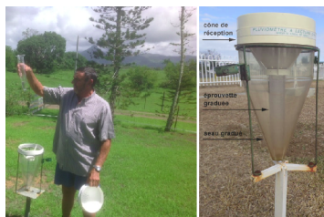
Pluviomètre à lecture directe
